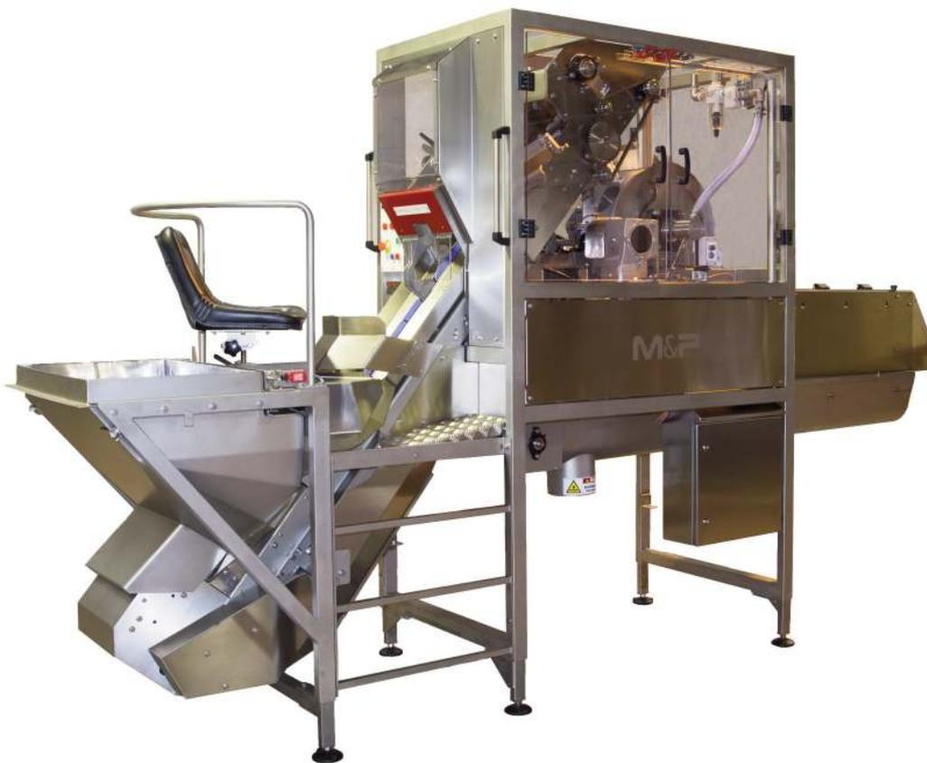
Ce système offre un processus complet pour les oignons de 45 à 115 mm de diamètre. Il étête et équeute les oignons en une seule opération, puis coupe la peau extérieure et l'enlève avec de l'air comprimé. Aucune pièce à changer n'est nécessaire. Les oignons sont prélevés automatiquement dans la trémie, puis positionnés par l'opérateur de manière à ce que les têtes et les queues soient placées horizontalement sur les supports.
