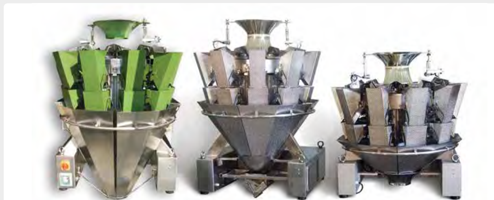
DA SINISTRA: per prodotti appiccicosi/surgelati - standard - per prodotti fragili From left: for sticky/frozen products - standard - for fragile products A gauche: pour produits gluants/surgelés - standard - pour produits fragiles
