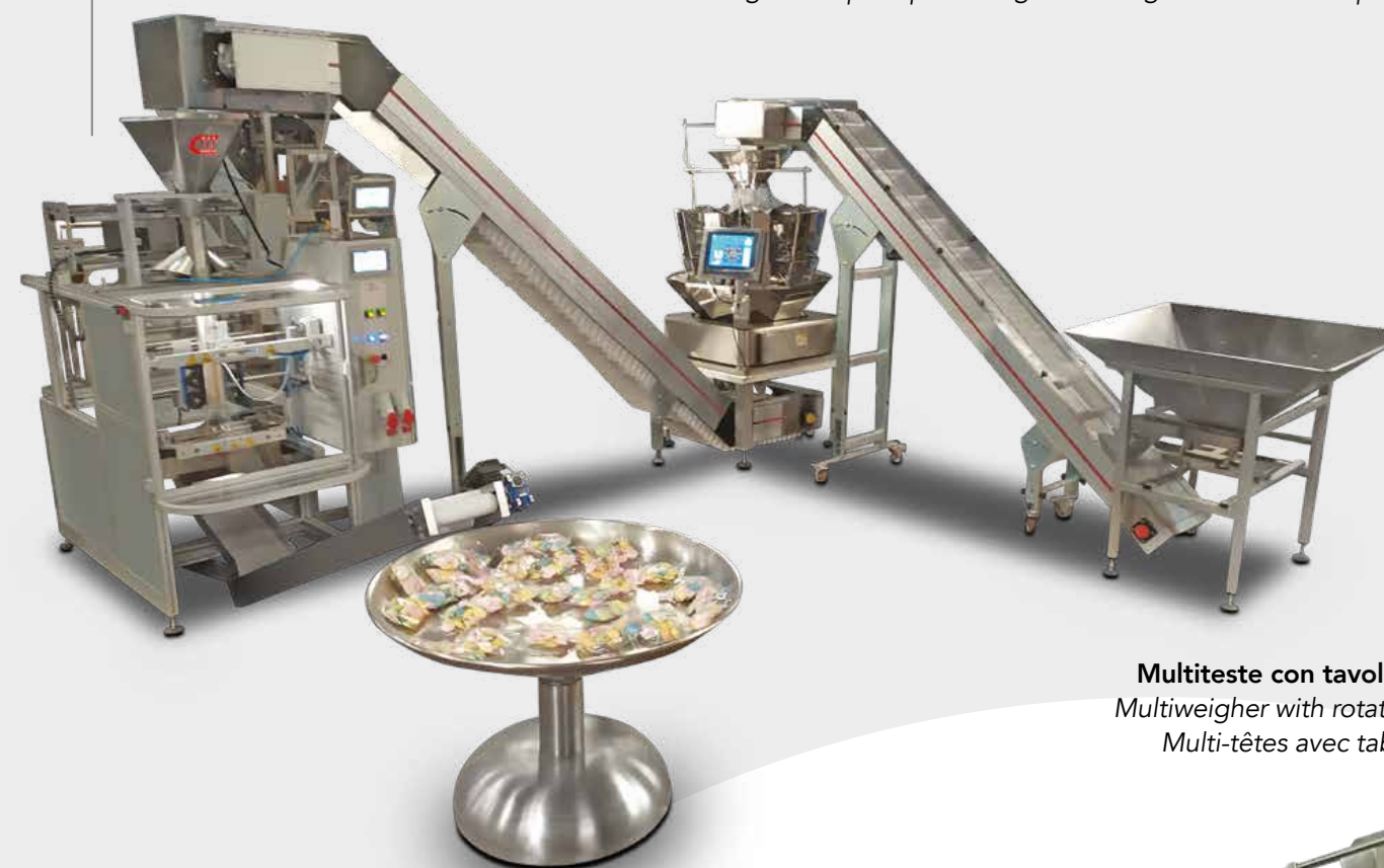
DA SINISTRA: per prodotti appiccicosi/surgelati - standard - per prodotti fragili From left: for sticky/frozen products - standard - for fragile products A gauche: pour produits gluants/surgelés - standard - pour produits fragiles
